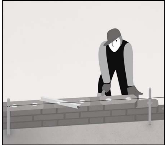
Kuva 6. Kerrokset ladotaan paikalleen puolen parin limityksellä siten, että pystysuorat reiät tulevat aina kohdakkain.
