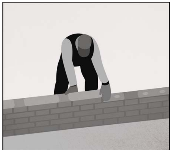
Kuva 9. Ylin kerros tehdään umpinaisesta päällyskivestä, joka voidaan liimata kiinni ilkivallan estämiseksi.
